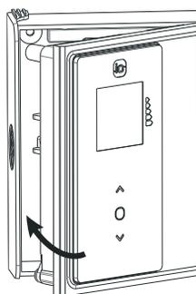
⑪ Repositionnez la partie avant dans la partie arrière du boîtier de commande.
