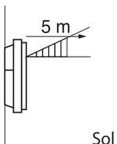
La détection ne se fait pas en dessous du capteur.
