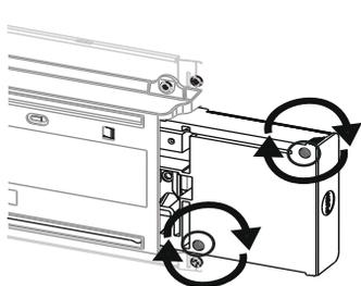
⑫ Remettez en place les deux vis de fixation de la partie arrière du boîtier de commande.
