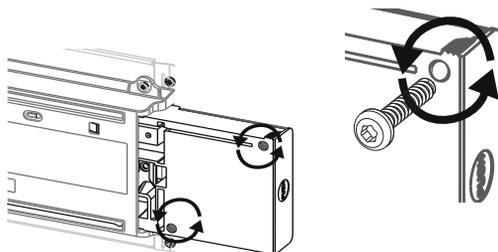
⑦ Retirez et conservez les deux vis de fixation de la partie arrière du boîtier de commande.
