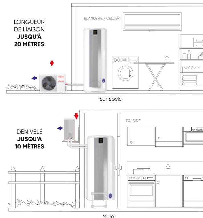
La pose d'un Split nécessite une attestation de capacité à manipuler les fluides frigorigènes.
