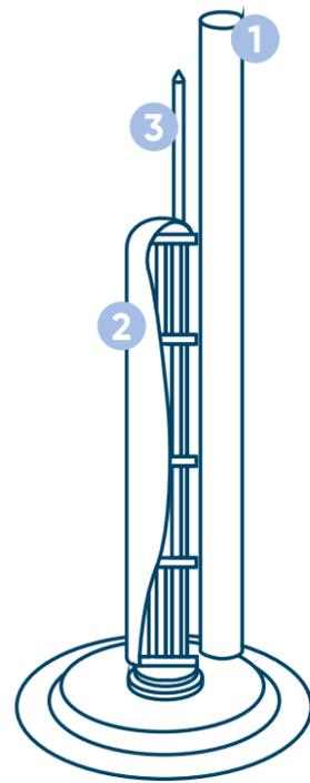
La résistance stéatite est placée dans un fourreau en acier émaillé. Elle n'est donc pas directement en contact avec l'eau de la cuve, ce qui diminue l'entartrage.
