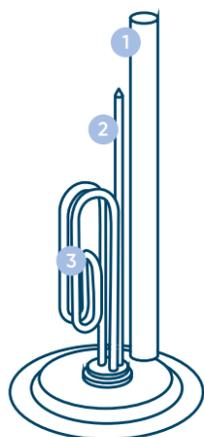
L'anode magnésium sert à protéger la cuve du chauffe-eau de la corrosion. Son action est cependant limitée dans le temps, l'entretien et éventuellement le remplacement de l'anode sont nécessaires le cas échéant (cf. notice).
