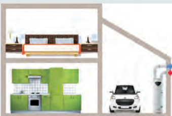
AIR EXTÉRIEUR AVEC GAINÉ POUR NE PAS REFROIDIR LA PIÈCE (HORS VOLUME CHAUFFÉ)
