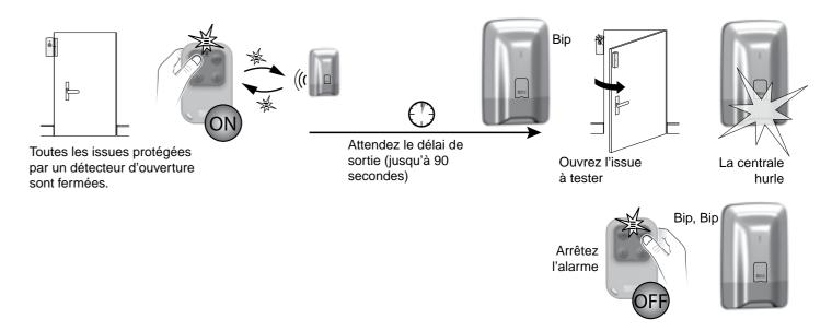
A chaque mise en marche ou arrêt du système, la centrale émet une série de bips, indiquant qu'un événement (ici la détection d'ouverture) s'est produit.
