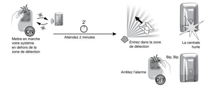
A chaque mise en marche ou arrêt du système, la centrale émet une série de bips, indiquant qu'un événement (ici la détection de mouvement) s'est produit. Vous pouvez le consulter sur un clavier tactile.
