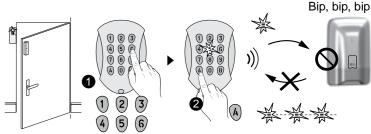
② Composez une 2º fois votre code d'accès suivi d'un appui sur (A) (ON) dans les 5 secondes qui suivent le 1er appui. Le voyant s'allume rouge puis vert pour valider l'action. La centrale émet un BIP.
