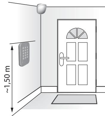
FR Il est conseillé d'installer le clavier près d'un des accès principaux, si possible protégé par un détecteur d'intrusion.
