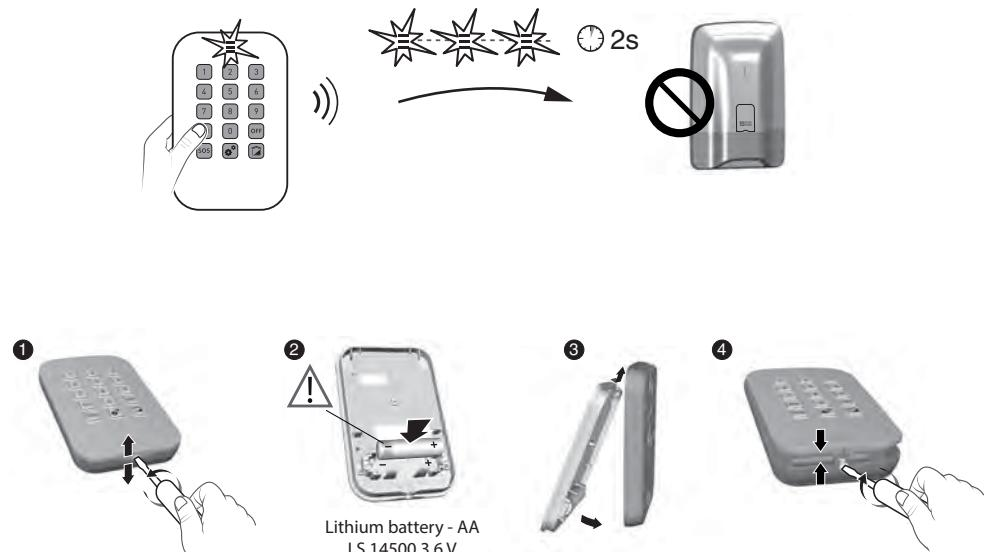
**FR** Le voyant clignote rouge à chaque appui, la pile est usée (< 2,7V). Avant d'ouvrir le boîtier, la centrale doit être en mode Maintenance (voir notice d'installation système).
