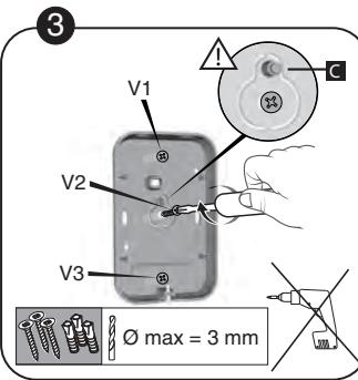
FR ③ Fixez le socle avec les vis V1, V2 et V3.
