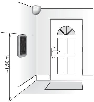
FR Il est conseillé d'installer le clavier près d'un des accès principaux, si possible protégé par un détecteur d'intrusion, et à hauteur du regard pour faciliter les manipulations.
