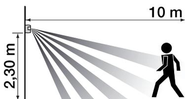
Pour protéger le plus de surface, le détecteur pourra être placé dans l'angle d'une pièce à **2,30 m du sol**.
